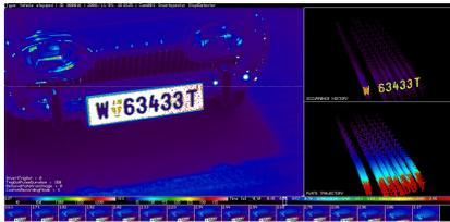
Zur Steigerung der Verkehrssicherheit hat Smartspector ein neuartiges Sensorsystem für ein mehrstufiges Gefahrenmanagement an Kreuzungen und Bahnübergängen entwickelt. Grundlage für die beiden Varianten Stop!Detector® und Red!Detector® bildet eine von Smartspector patentierte Erfindung, die die Position des Kennzeichens im zeitlichen Verlauf bewertet.
